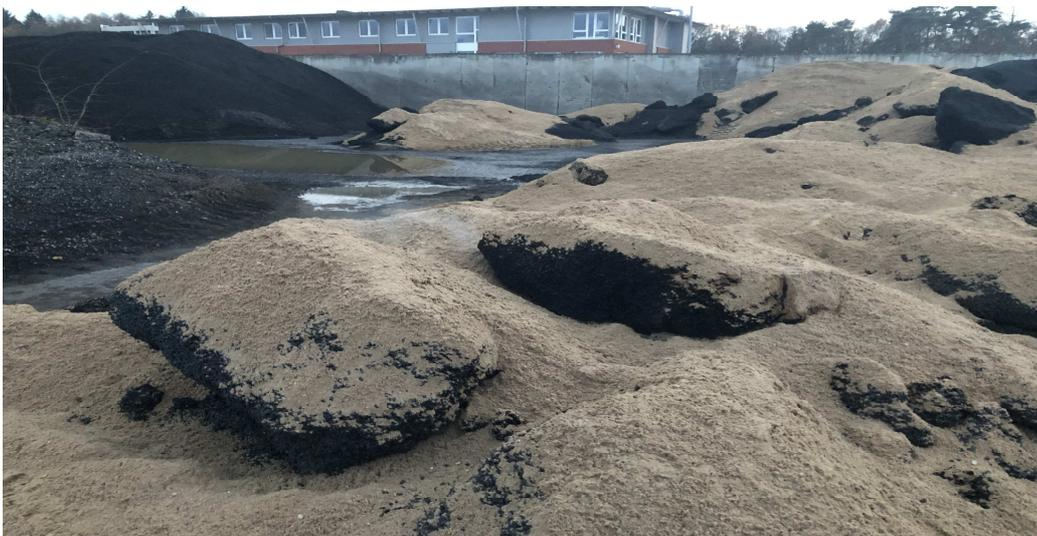
Abb. 14 Mit Sand abgedeckte Haufen mit Asphalt-Fehlchargen
