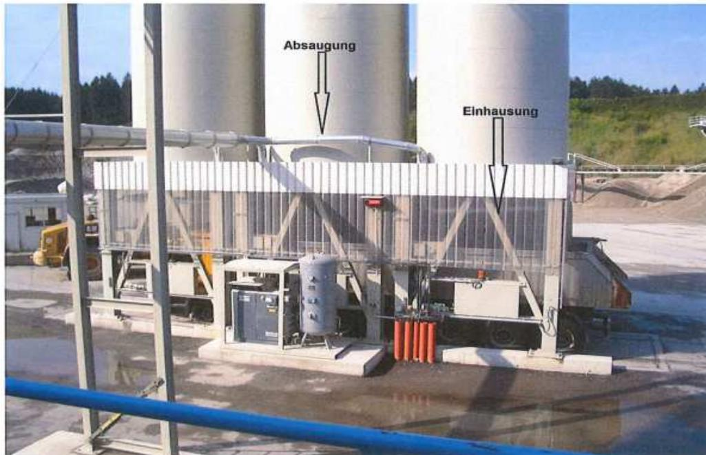
Abb. 12 Einhausung und Absaugung des Verladebereichs an einer Asphaltmischanlage
