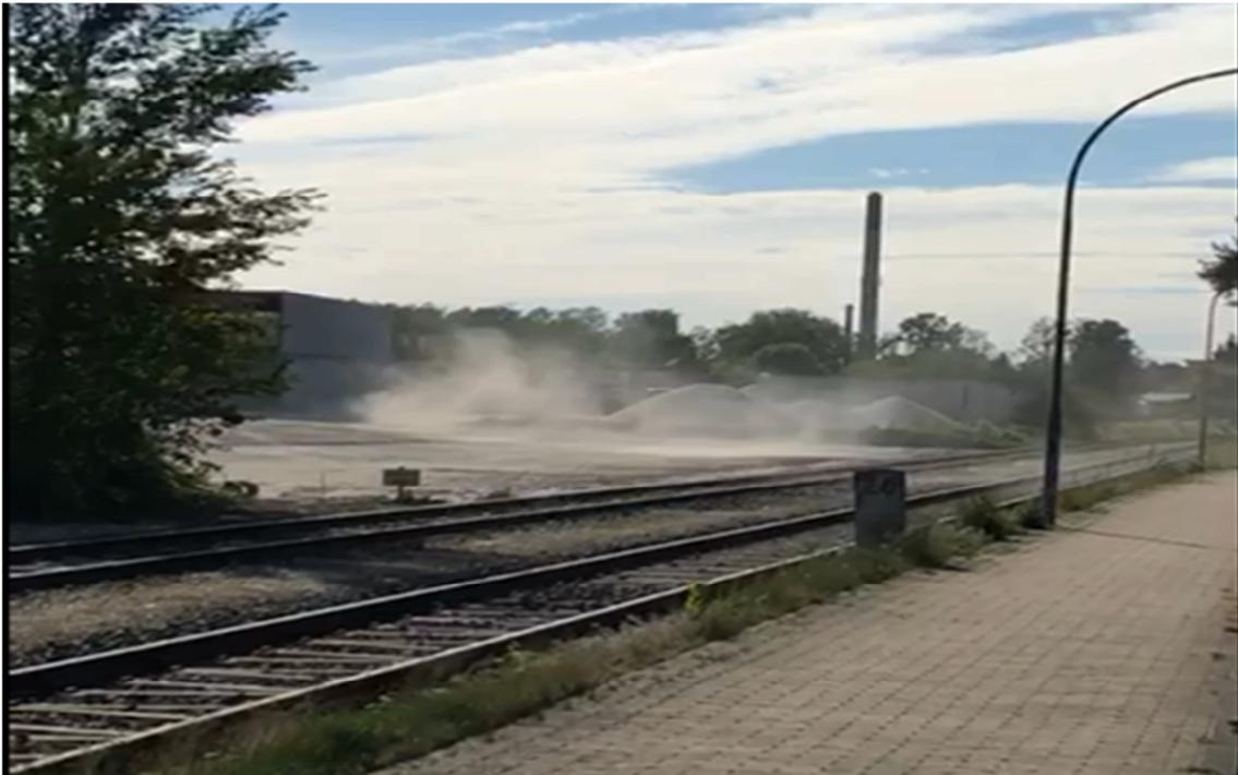
Abb. 5 Abtrag von Staub von Betriebsflächen und Halden des Asphaltwerkes bei erhöhten Windgeschwindigkeiten
